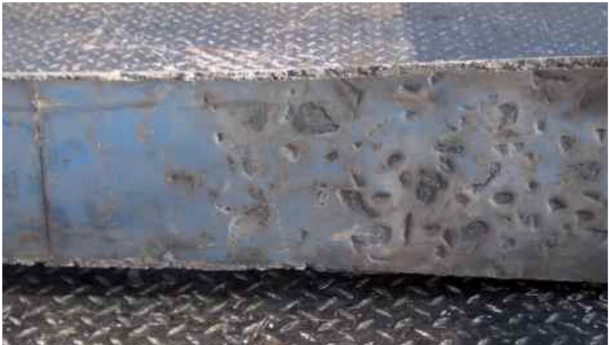
Obr. 3.3.1 Podložky společnosti Getzner SLB 2210G po 190 milionech celkových tun. [26]
