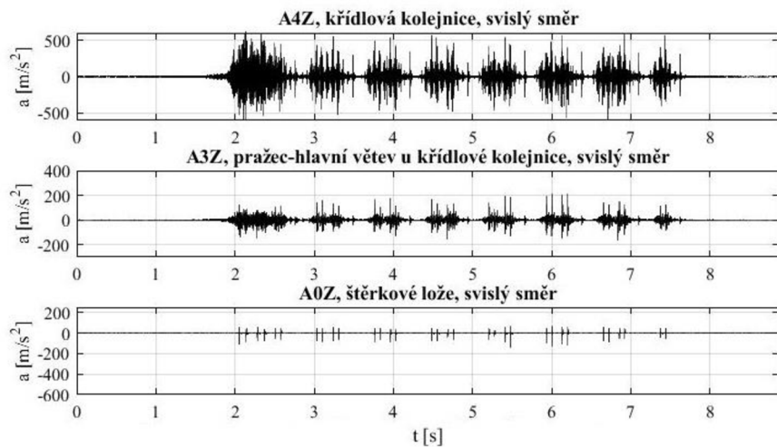
Obr. 6.2.5 Srovnání grafů zrychlení vibrací, výhybky č. 3 a 4 při průjezdů vlakových souprav 380 a RegioJet
