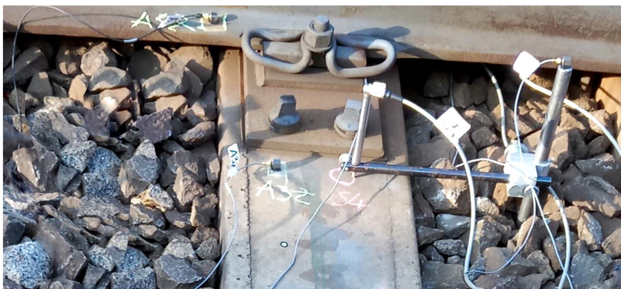
Obr. 5.2.2 Náhled umístění snímačů, zjednodušená metodika
