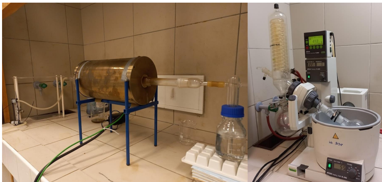
Obrázek 11: Aparatura s trubkovou pecí a vakuová rotační odparka
