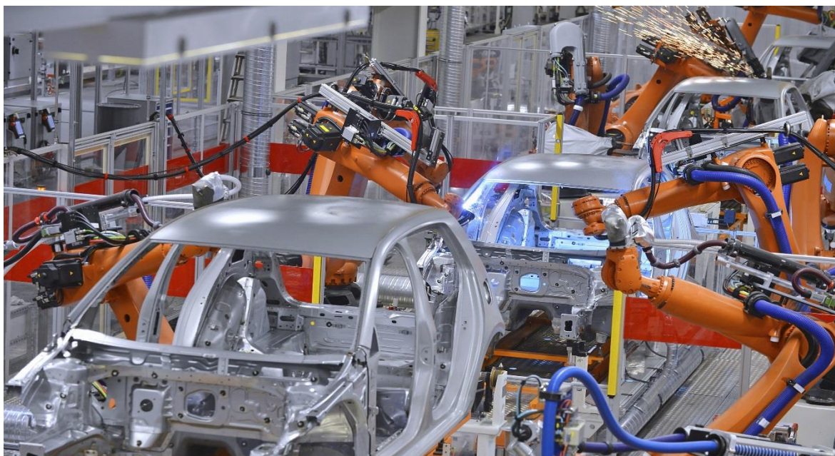
Obr. 2 - výroba okované karosérie
