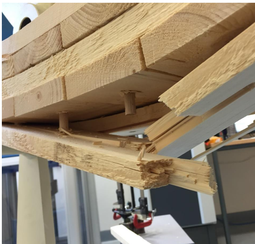
Obr. 36 Vytažení kolíku deformace spodní desky panelu
