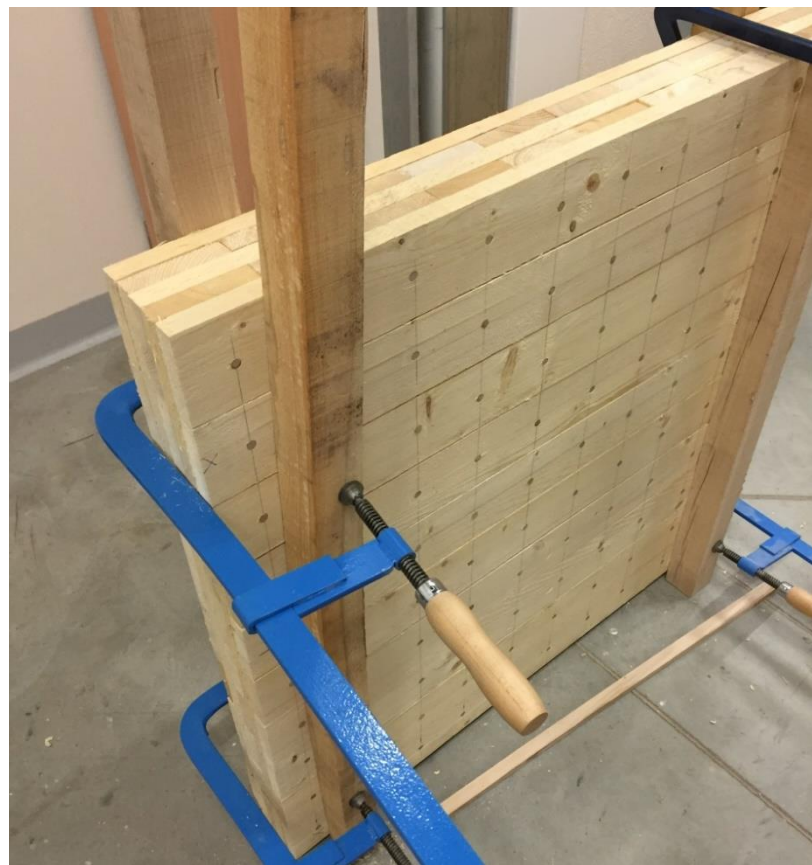
Obr. 13 Klimatizace hotových panelů
