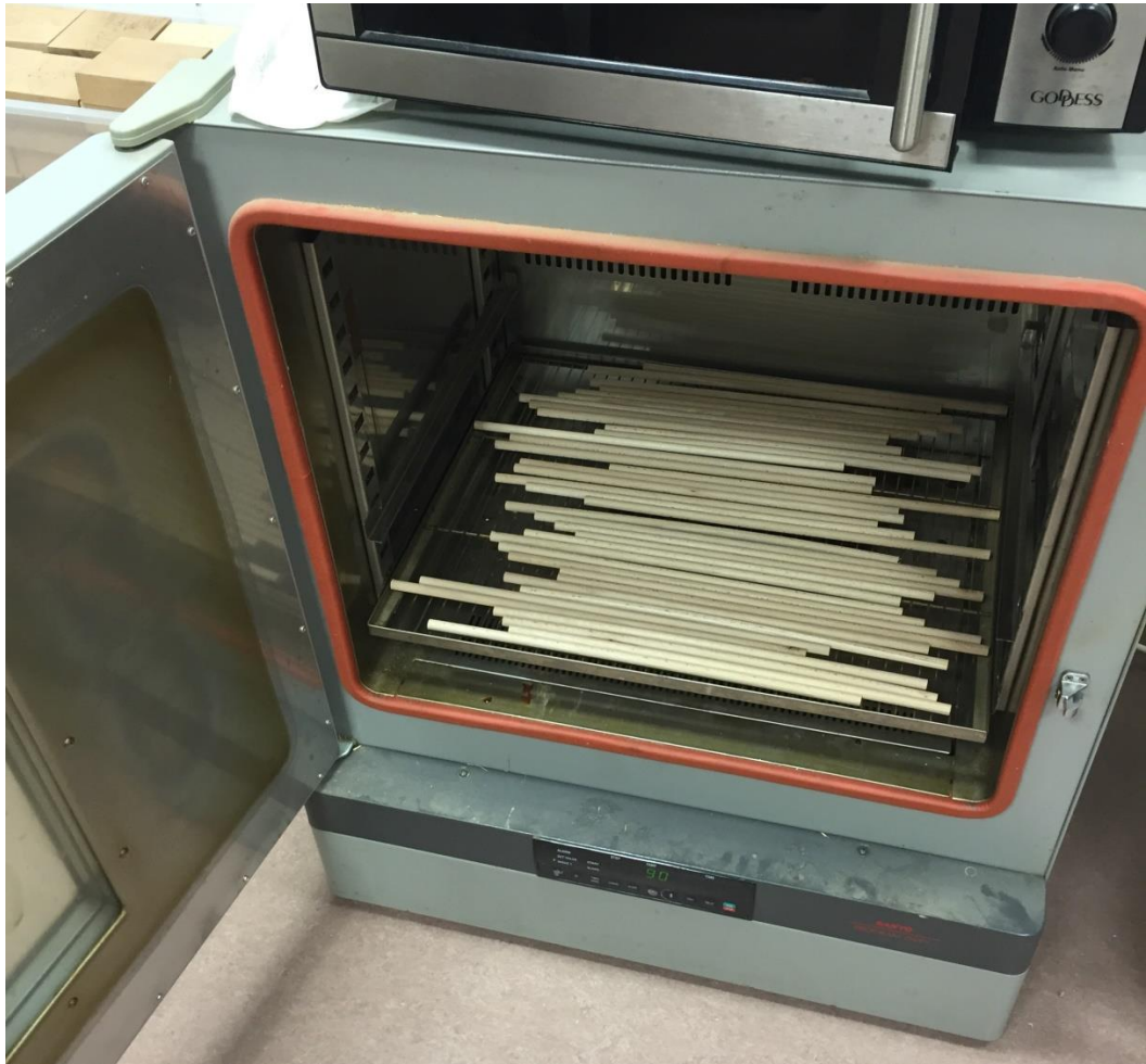
Obr. 15 Sušení kolíků na nulovou vlhkost
