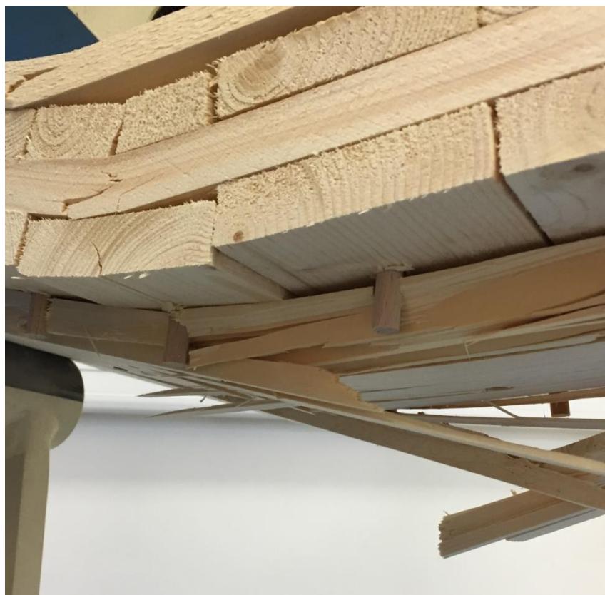
Obr. 38 Podélné rozštípnutí lamely panelu při ohybové zkoušce
