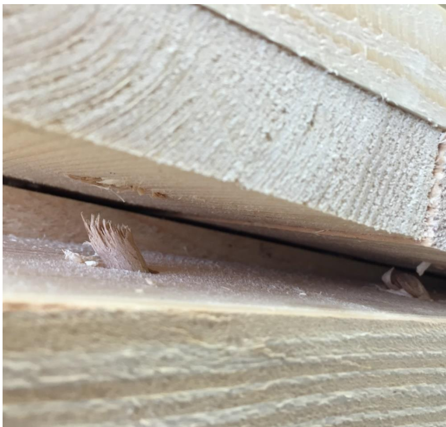
Obr. 37 Střih kolíku při ohybové zkoušce
