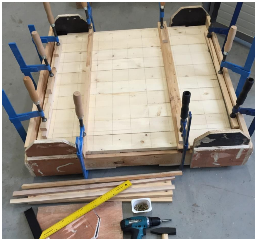
Obr. 10 Zajištění lamel proti pohybu při vrtání
