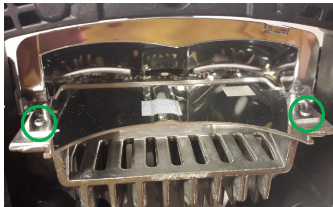
Obr. 4.3 Rozrivetované piny chladiče [5].
