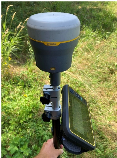
Obr. 44 GNSS rover typu Trimble R12 (Majkus, VIII/2021)
