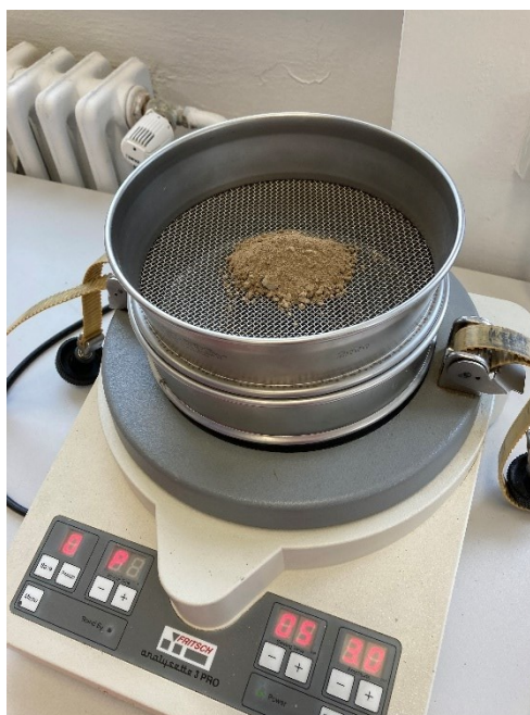
Obr. 49 Vzorek na sítu (2 mm) na vibračním přístroji (Majkus, IX/2021)
