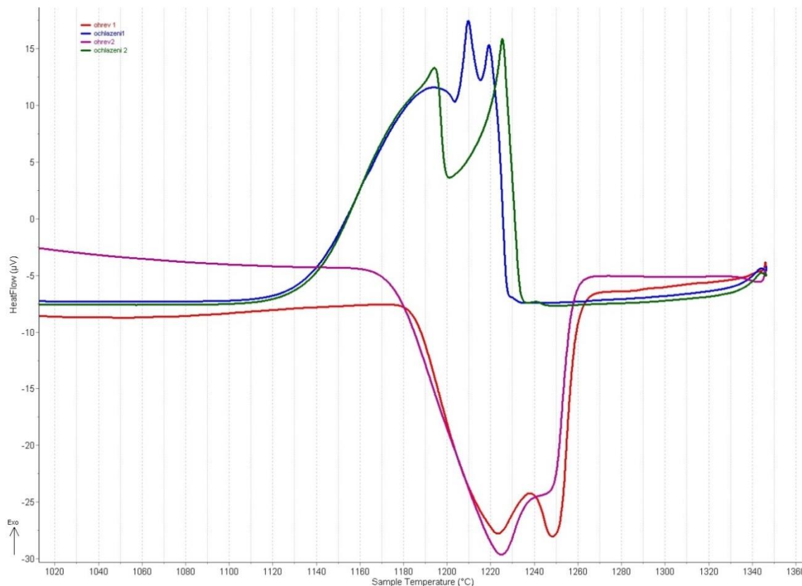
Obr. 3.1 Graf závislosti tepelného toku na měnící se teplotě metodou DSC
