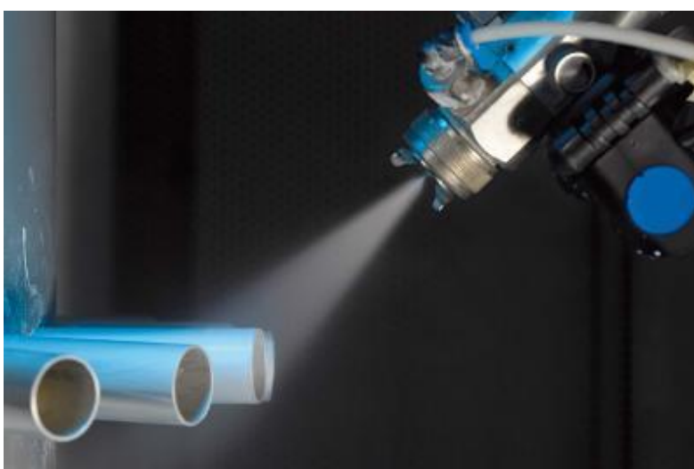
Obr. 2.4 Nanášení tavidla stříkací pistolí [2].
