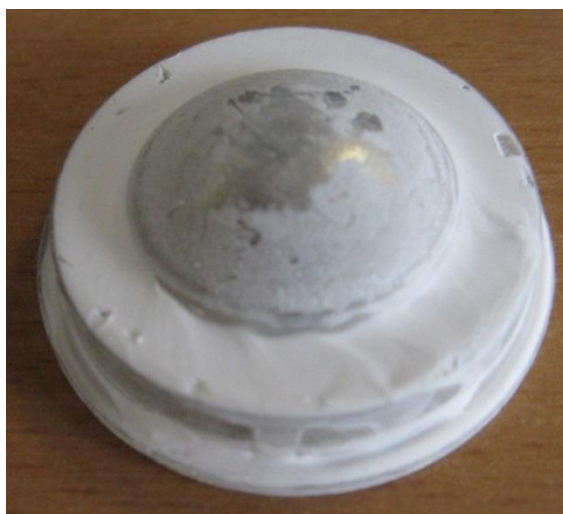
Obr. 2.5 Tavidlo nanesené na R-D víčku.
