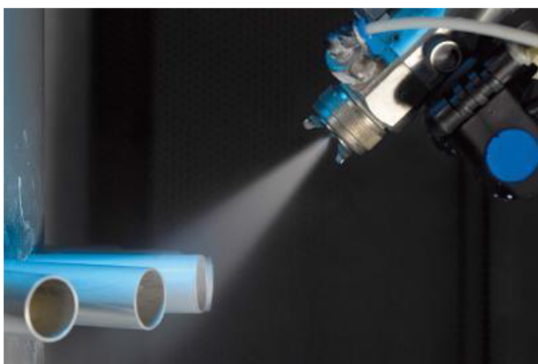
Obr. 2.4 Nanášení tavidla stříkací pistolí [2].
