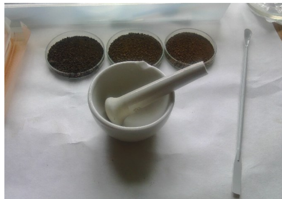
Pro rozemletí byla použita třecí miska s tloučkem.
