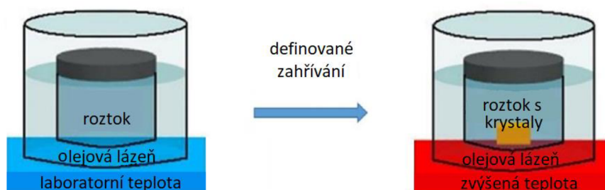
Obr. 3: Schéma přípravy perovskitových krystalů metodou ITC, upraveno z [2]
