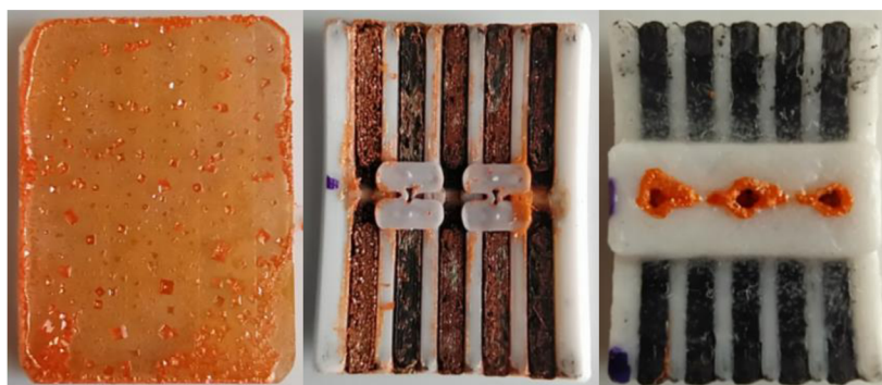
Obr. 16: Podložky po nanesení roztoku perovskitu vždy do každého kanálu: Ossila ITO podložka (vlevo), podložka z PLA prvního druhu (uprostřed) a podložka z PLA druhého druhu po zalepení elektrod (vpravo)
