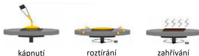
Obr. 7: Schéma metody jednokrokového rotačního nanášení pro přípravu perovskitové vrstvy, upraveno z [14]
