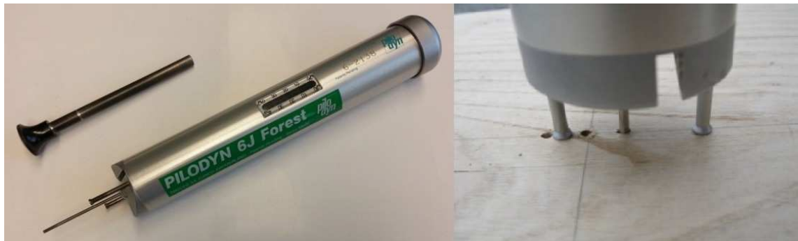
Obr. 3 Příklad přístroje PILODYN 6J (Kuklík a Hasníková, 2013); detail trnu přístroje (Kotlínová a kol., 2008)
