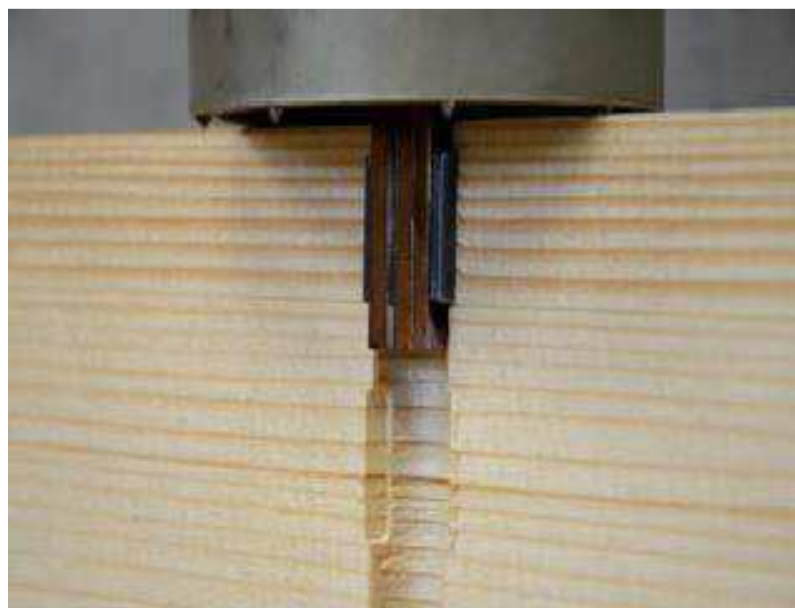
Obr. 6 Otláčení čelistí viditelné na řezu testovaným prvkem (Kloiber a kol., 2014)
