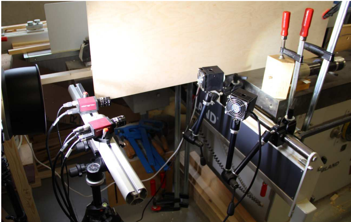
Obr. 13 Fotografie aparatury při měření wood testKLOIBerem při současném snímání pomocí DIC
