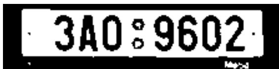
Obr. 6.11: Prahovanie regiónu EČV metódou Otsu
