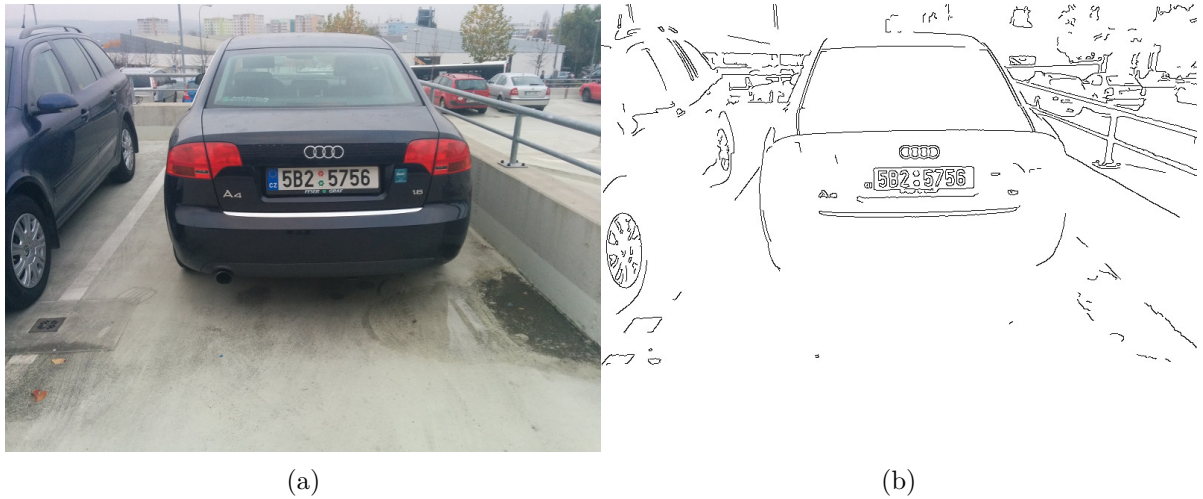
Obr. 4.3: Porovnanie (a) originálu a (b) obrazu po aplikácii Cannyho detektora hrán
