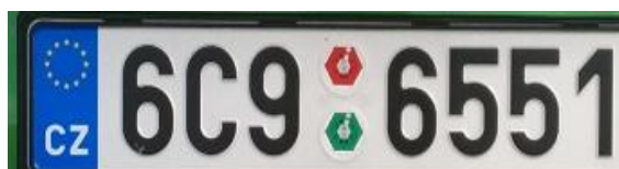
Obr. 6.7: Finálny výrez EČV získaný pomocou detekcie vertikálnych hrán v obraze
