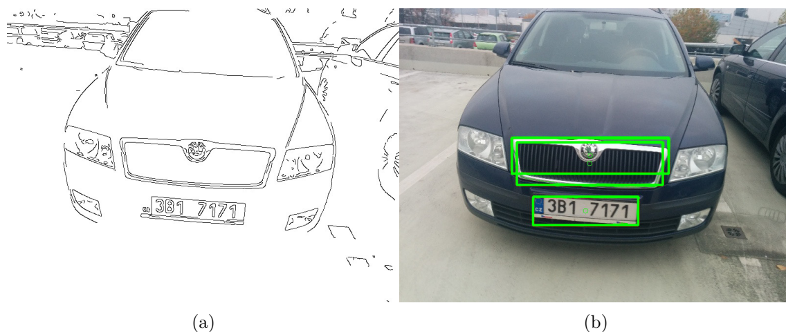
Obr. 6.8: Obráz z (a) Cannyho detektora a (b) kandidátne regióny
