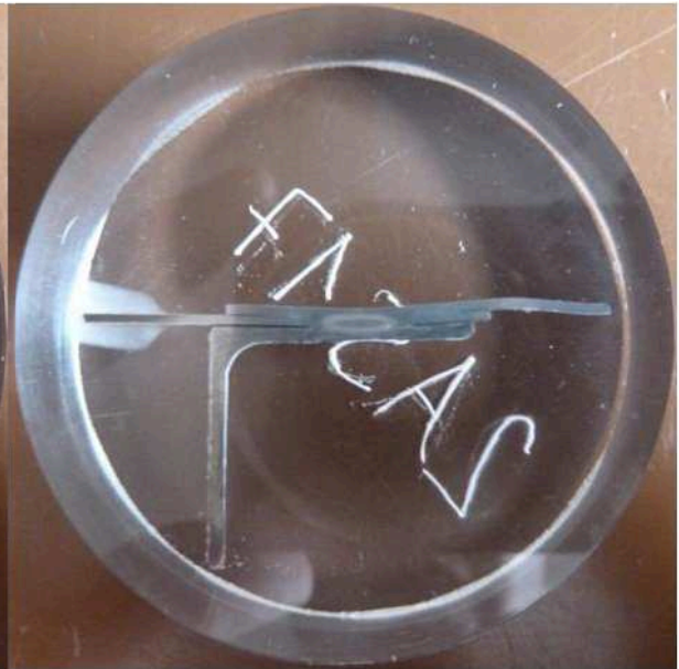
Obr. 9.2.1b Metalografický vzorek svarového spoje, konstrukční uzel plech – plech - úhelník, doba expozice 480 h a 1000 h
