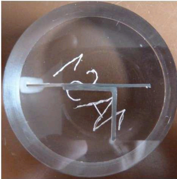
Obr. 9.2.1a Metalografický vzorek svarového spoje, konstrukční uzel plech – úhelník, doba expozice 480 h a 1000 h
