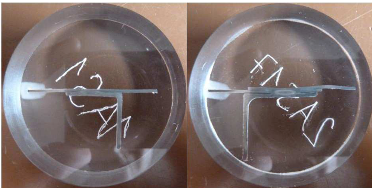
Obr. 9.2.1a Metalografický vzorek svarového spoje, konstrukční uzel plech – úhelník, doba expozice 480 h a 1000 h
