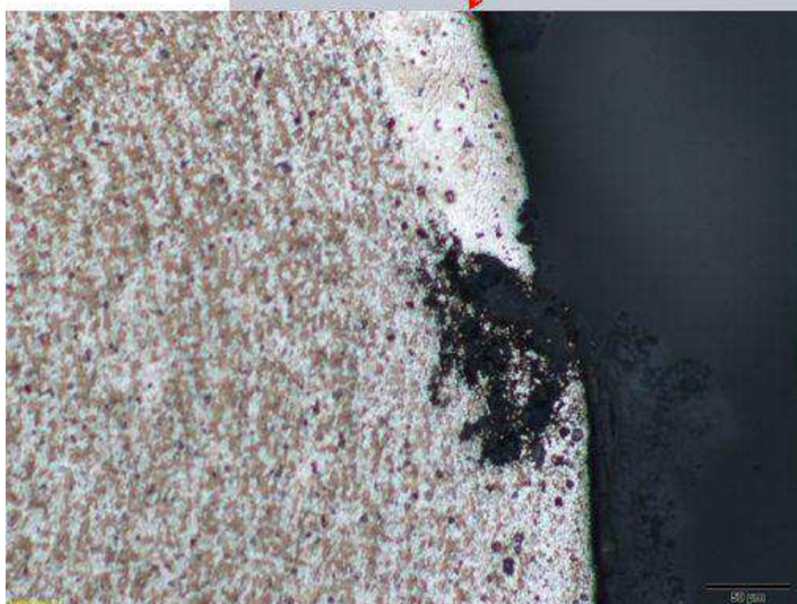
Obr. 10.2. Příklad korozního napadení na konstrukčním uzlu plech – úhelník, doba expozice 1000 h
