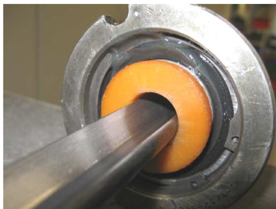
Obr. 5.3: Ložisko s plastovým pouzdrem, drážka ve tvaru V v těle vrtáku.
