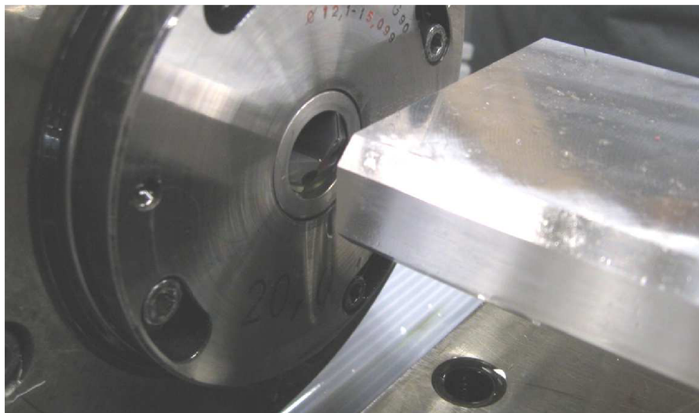
Obr. 1.2: Hlavička vrtáku ve vrtacím pouzdrům při najíždění k obrobku.
