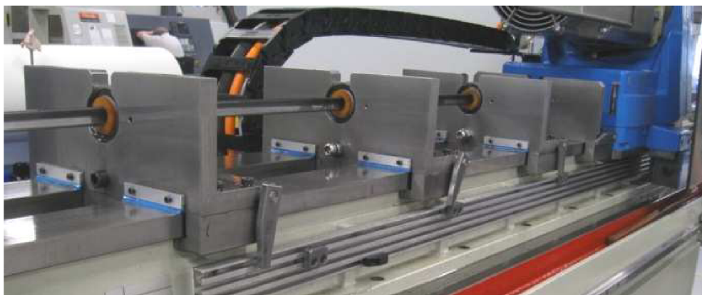
Obr. 5: Vrtací tyč nástroje uložená v lunetách.
