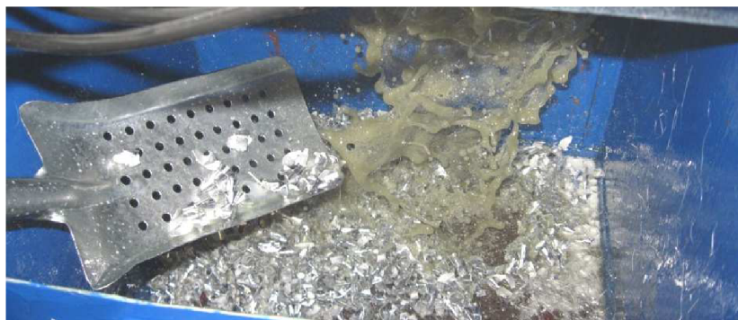
Obr. 5.1: Hrubé čištění třísek z řezného oleje.
