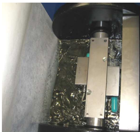
Obr. 5.2: Filtrování řezného oleje přes pásový papírový filtr.
