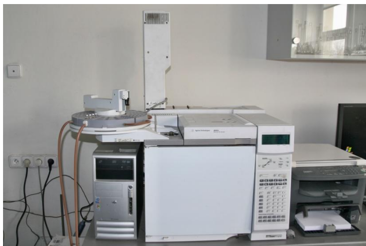
Obrázek č. 7: Plynový chromatograf s plamenově ionizačním detektorem
