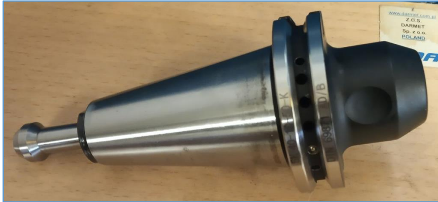
Obr. 6.14 upínač Weldon SK 40–10–50–K.
