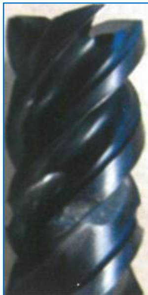
Obr. 4.8 Vrubové opotřebení frézy [10].
