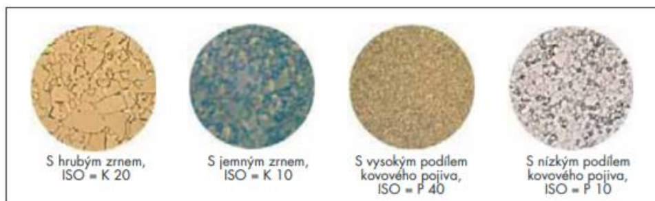
Obr. 2.3 Mikrostruktury různých typů slinutých karbidů [6].
