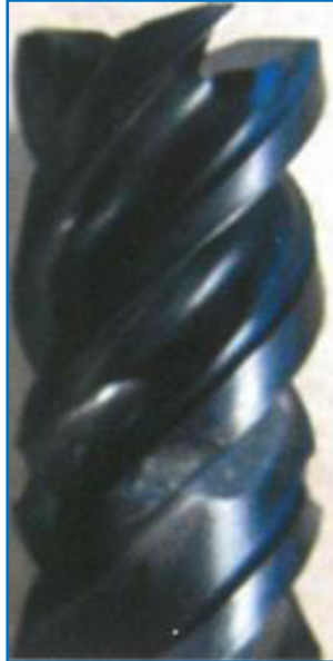
Obr. 4.8 Vrubové opotřebení frézy [10].
