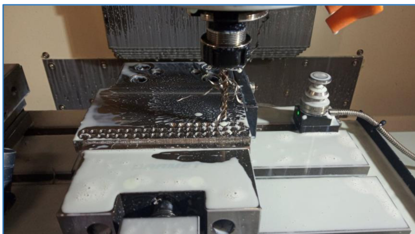
Obr. 8.1 Namotávání třísek u nástroje V1.
