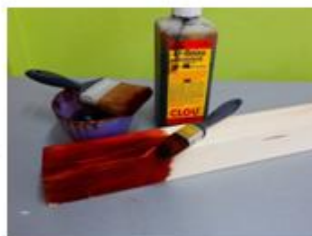
Obr. 13 Moření: štětec nanášecí a „kartáčovací“
