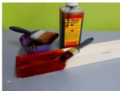
Obr. 13 Moření: štětec nanášecí a „kartáčovací“
