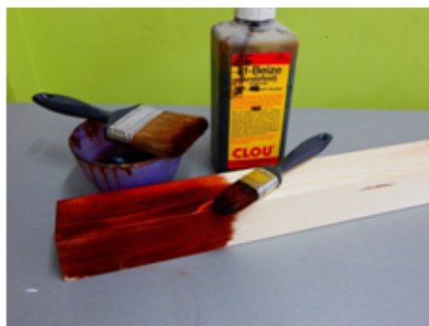
Obr. 13 Moření: štětec nanášecí a „kartáčovací“
