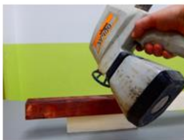
Obr. 14 Nanášení laku elektrickou stříkačká pistolí
