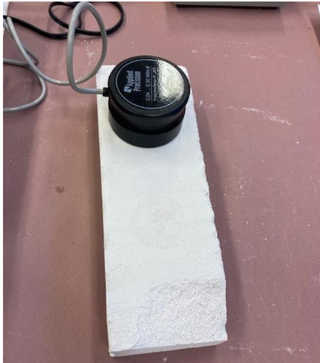
Obrázek 17 – Měření tepelné vodivosti pórobetonových tvárnic
