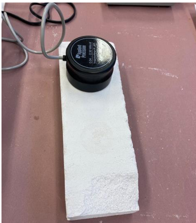
Obrázek 17 – Měření tepelné vodivosti pórobetonových tvárnic
