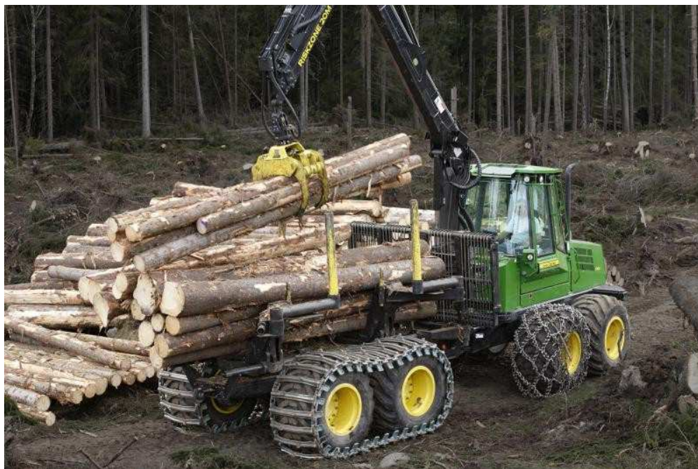
Obr. č. 5- Vyvážecí traktor John Deere 1110D ( www.merimex.cz )
