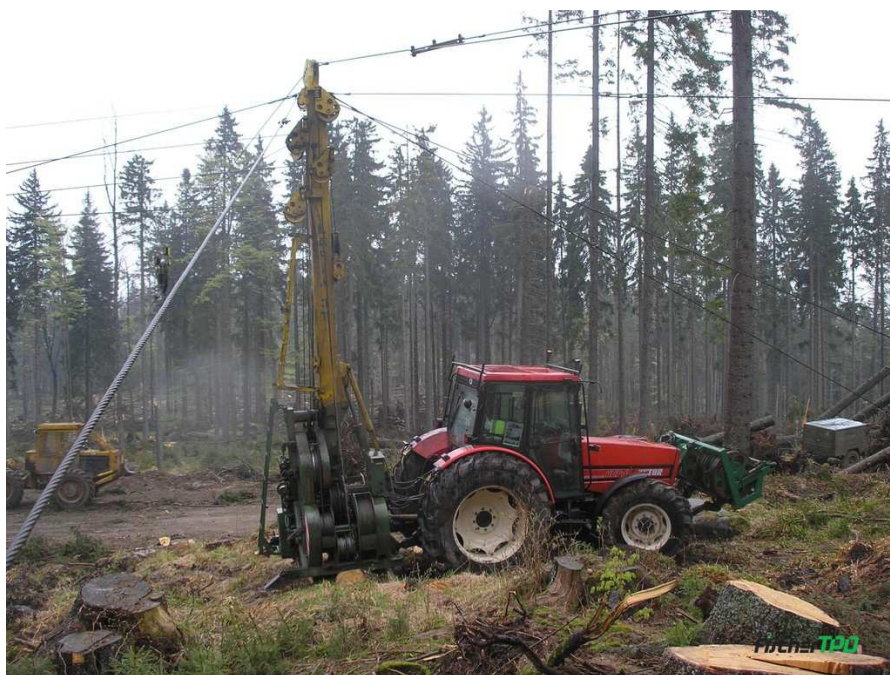
Obr. č. 1: Lanové dopravní zařízení LARIX 550 (foto Radek Fišer)
