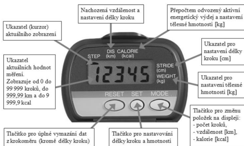
Obrázek 2: Displej pedometru Yamax Digiwalker SW-700 s popisem ovládacích prvků (Sigmund, 2012)
