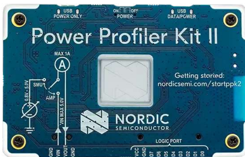
Obrázek 2.6: Fotografie analyzátoru napájení Nordic Semiconductor Power Profiler Kit II, převzatá ze stránek produktu[22]
