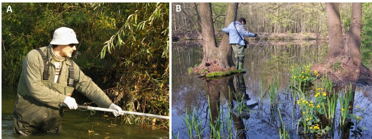
Obrázek 4: Byšická tůň. A) Elektrolov juvenilních sumců velkých ( Silurus glanis L.), B) radiotelemetrické sledování pomocí směrové Yagi antény. (Foto: Miloslav Petrtýl)
