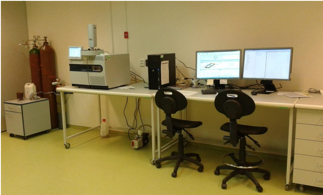
Obrázek 21: Příklad Bruker EVOQ™ GC Triple Quadrupole (TQ) s MS detekcí a autosamplérem CP-8400
