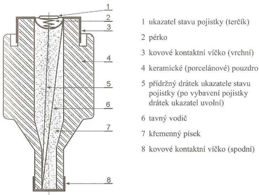
Obr. 13 Konstrukce pojistkové vložky (patrony)
