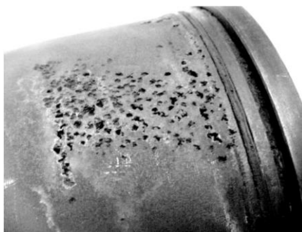
Obr. 26 Kavitačné opotrebenie pláštu piestu [44]
