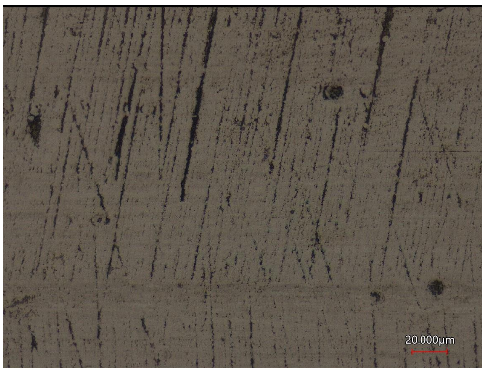
Obr. 47 Finálny povrch teniaceho piestneho krúžku s povlakom CrCN47
