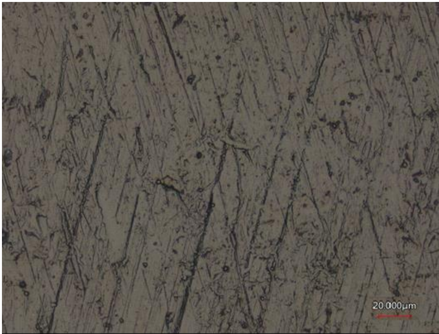
Obr. 48 Finálny povrch teniaceho piestneho krúžku s povlakom DLC
