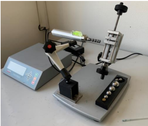
Obr. 50 Zariadenie CALOTEST CSM vľavo, Schéma calotestu vpravo
