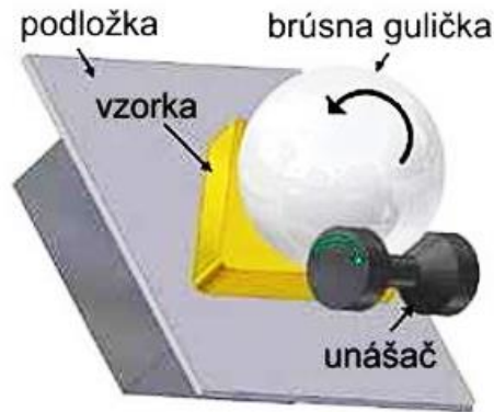
Obr. 50 Zariadenie CALOTEST CSM vľavo, Schéma calotestu vpravo
