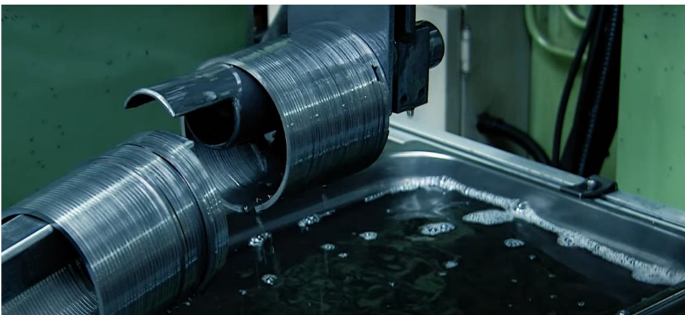
Obr. 39 Čistenie piestnych krúžkov v ultrazvukovej pračke
