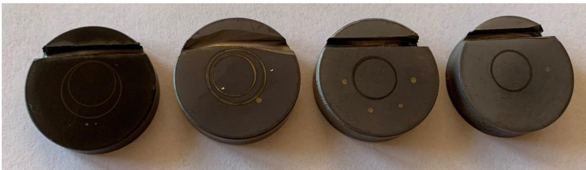
Obr. 49 Použité vzorky, Zľava DLC, CrCN47, CrCN48, CrN
