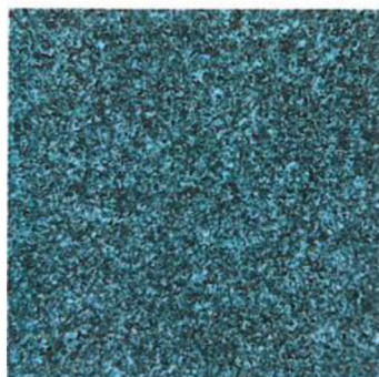
Obr. 34 Štruktúra materiálu BS-13, leptané Nital, zväčšenie 500x
