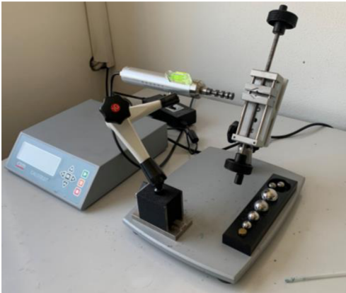
Obr. 50 Zariadenie CALOTEST CSM vľavo, Schéma calotestu vpravo
