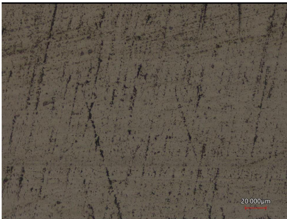
Obr. 46 Finálny povrch teniaceho piestneho krúžku s povlakom CrCN48
