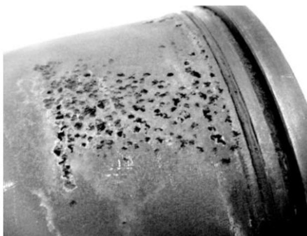
Obr. 26 Kavitačné opotrebenie pláštu piestu [44]
