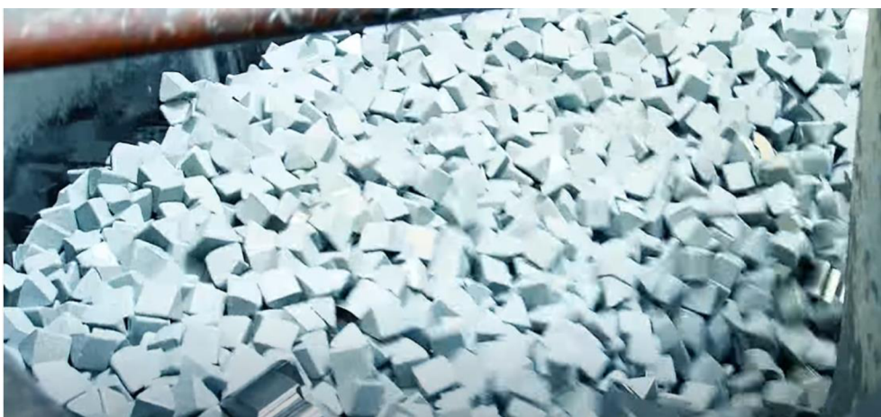
Obr. 38 Pranie piestnych krúžkov s omývacími kameňmi
