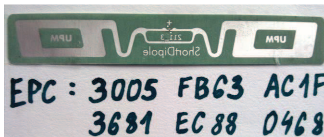
Obr. 3.17 Tag UPM Short Dipole na papírovém podkladu.
