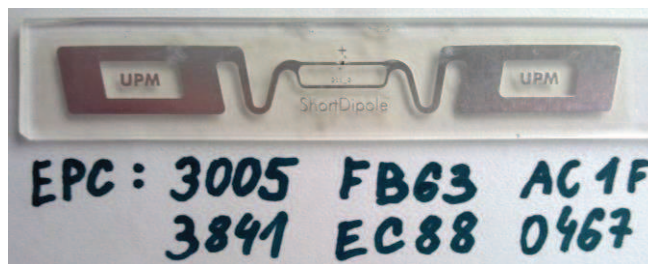
Obr. 3.16 Tag UPM Short Dipole na podkladu z průhledné fólie.
