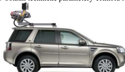
Obrázek 26 Trimble MX9 na střeše vozidla. [15]
