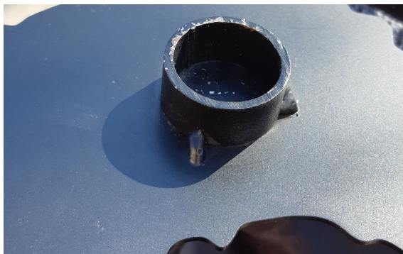
Obrázek 9 – 1. Způsob povrchové úpravy (viditelné mech. Poškození).
