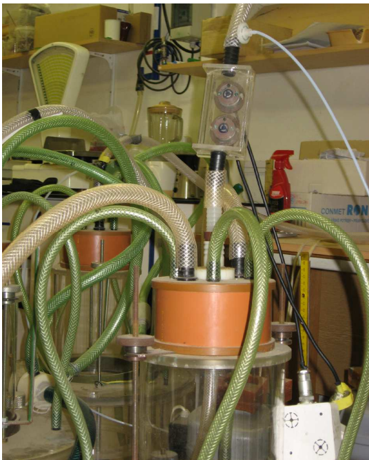
A4. Umístění sond elektronického snímače osazeného polovodičových senzorem SP-53 a sondy analyzátoru Photoacoustic Multi-gas Monitor na výstupu z reakční nádoby
