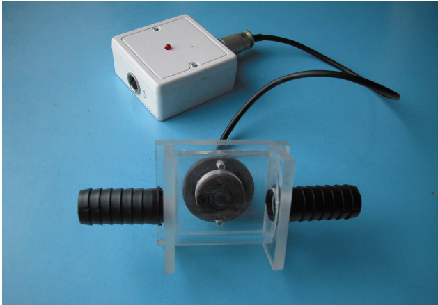
A1. Elektronický snímač osazený polovodičovým senzorem SP-53; externí sonda se senzorem je umístěna v pouzdru pro měření v laboratorních podmínkách
