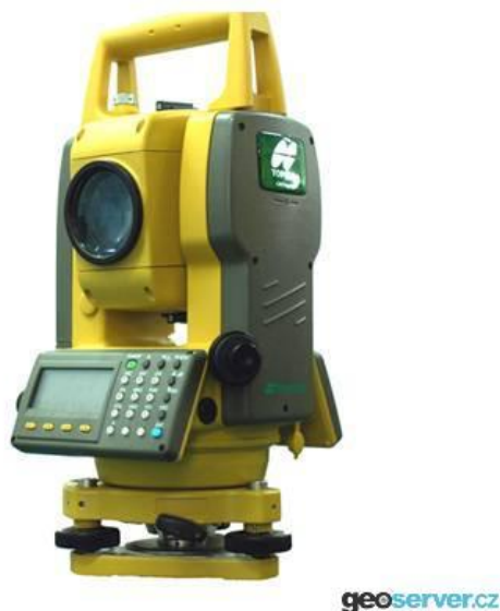
Obr. č. 12 – Totální stanice ( http://www.geoserver.cz )
