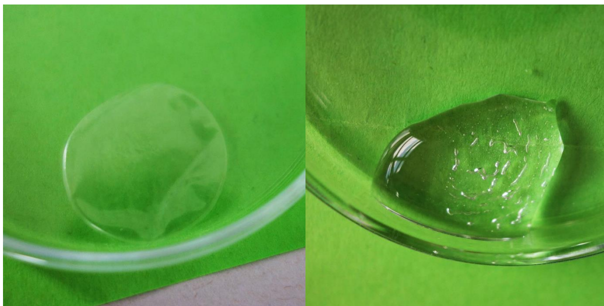
Obrázek 37 Produkt před a po přidání ultračisté deionizované vody; HYA s obsahem 5 % (w/w HYA) CA
