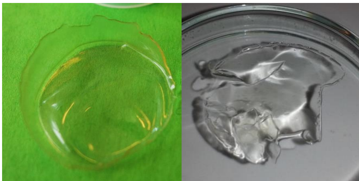
Obrázek 27 Produkt před a po přidavku ultračisté deionizované vody; HEC s obsahem 20 % CA (w/w HEC)
