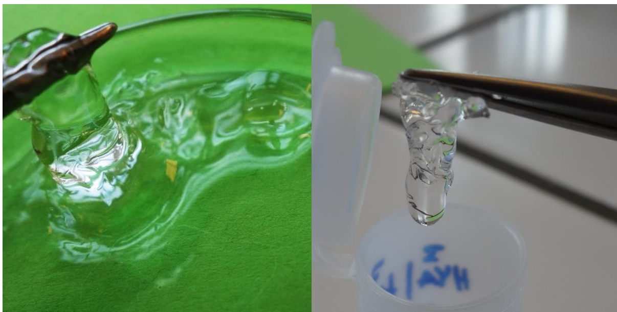
Obrázek 31 Produkty po přidání ultračisté deionizované vody; HYA a HEC v hmotnostním poměru 3 : 7 s obsahem 5 % CA (w/w směsi) vlevo, s obsahem 10 % CA (w/w směsi) vpravo
