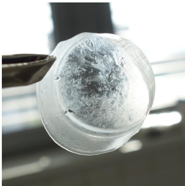
Obrázek 43 Nehomogenní struktura produktu
