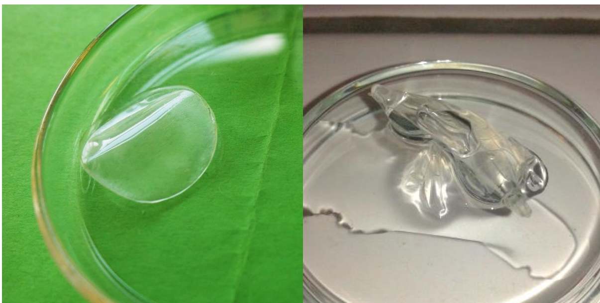
Obrázek 32 Produkt před a po přidavku ultračisté deionizované vody, HYA a HEC v hmotnostním poměru 3 : 7; koncentrace CA 20 % (w/w polymeru)
