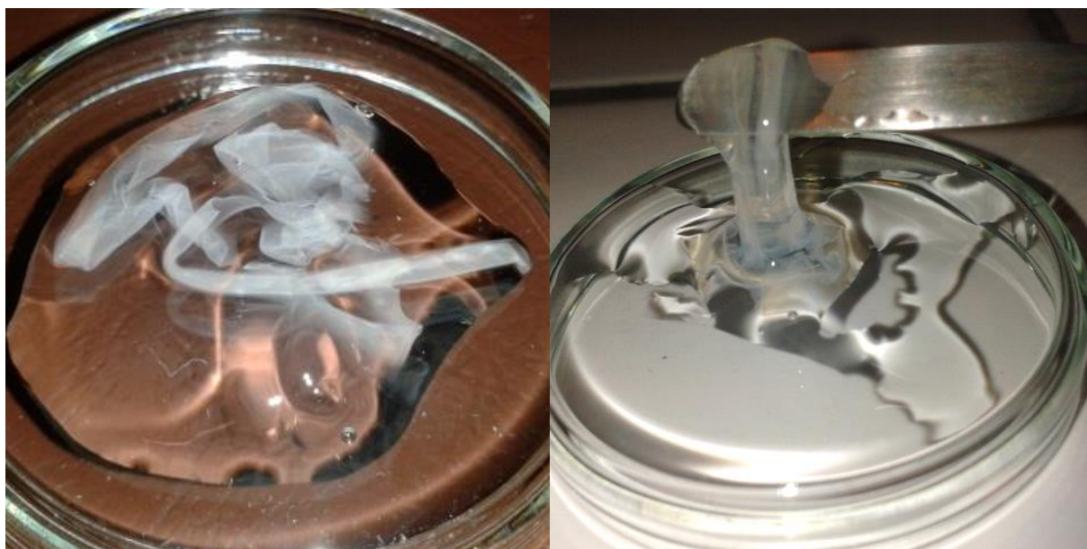
Obrázek 35 Produkty po přidavku ultračisté deionizované vody; HYA a HEC v hmotnostním poměru 7 : 3 s obsahem 20 % CA (w/w směsi)
