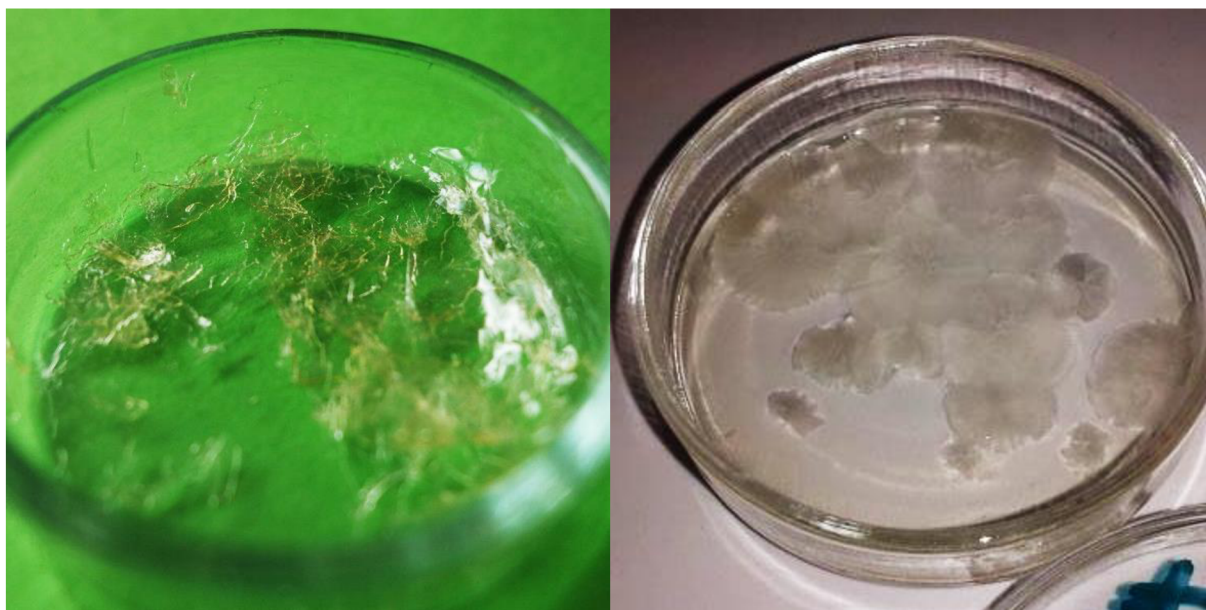
Obrázek 24 Vzorky po gelaci obsahující nadbytek kyseliny citronové (CA); hmotnostní poměr HEC a CA 1 : 1 vlevo, 20 % CA (w/w HEC) vpravo
