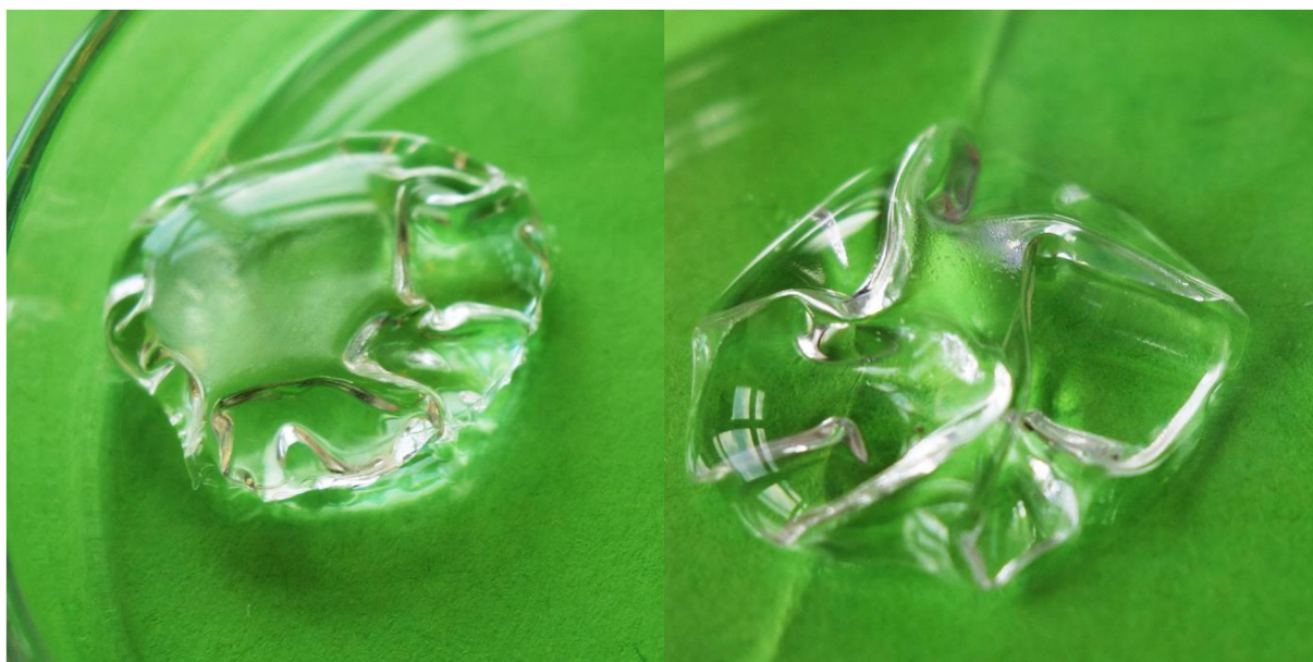
Obrázek 34 Produkty po přidavku ultračisté deionizované vody; HYA a HEC v hmotnostním poměru 7 : 3 s obsahem 5 % CA (w/w směsi) vlevo, s obsahem 10 % CA (w/w směsi) vpravo
