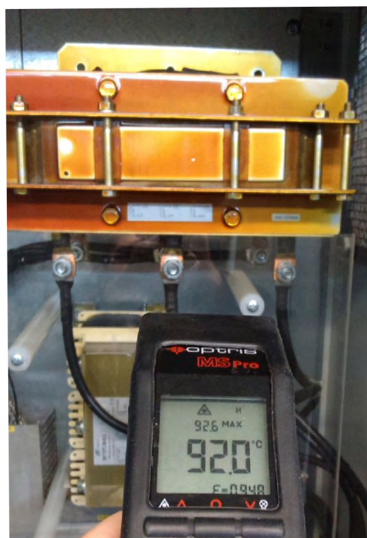
Obrázek 14.6 Měření teploty AC sinusového filtru bez použití navrhnutého filtru DP
