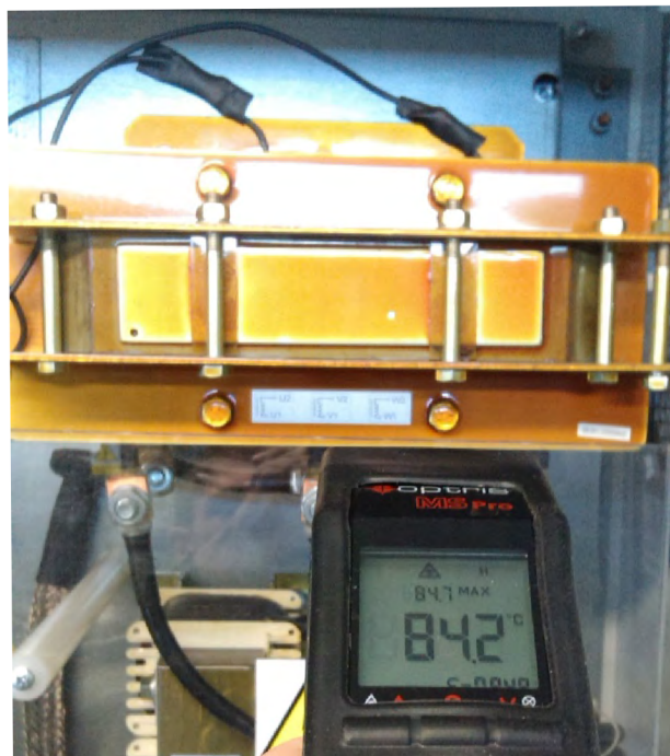
Obrázek 14.5 Měření teploty AC sinusového filtru při použití navrhnutého filtru DP
