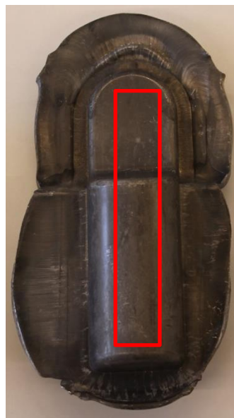
Obr. 24 Místo odebrání vzorku pro statickou zkoušku tahem
