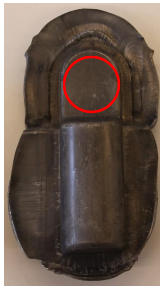
Obr. 27 Oblast měření tvrdosti dle Brinella HBW2,5/62,5 na výkovku
