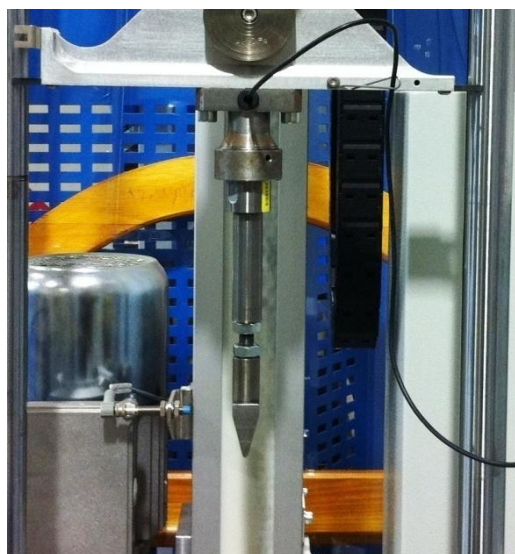
Obr. 3.9: Namontovaný břit připravený pro měření
