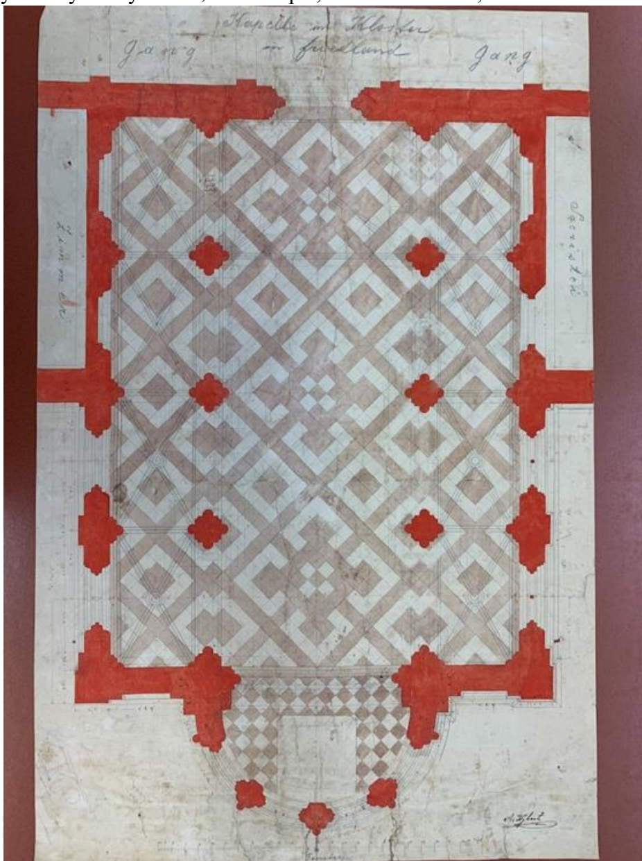
Příloha č. 45 – Návrh půdorysu kaple s geometrickým uspořádáním dlaždic do čtverců vytvořený A. Kybastem, In: ZAOpO, ÚRAS Kroměříž, inv. č. 54720
