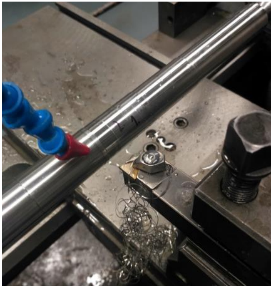
Obrázek 31 Příprava vzorku pro měření drsnosti
