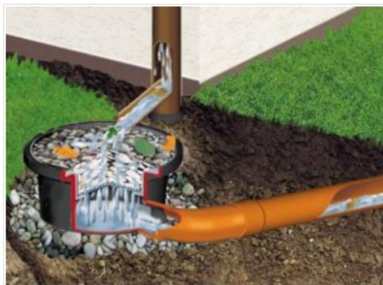
Obr. 7 Filtrační hrnec (URL 20)
