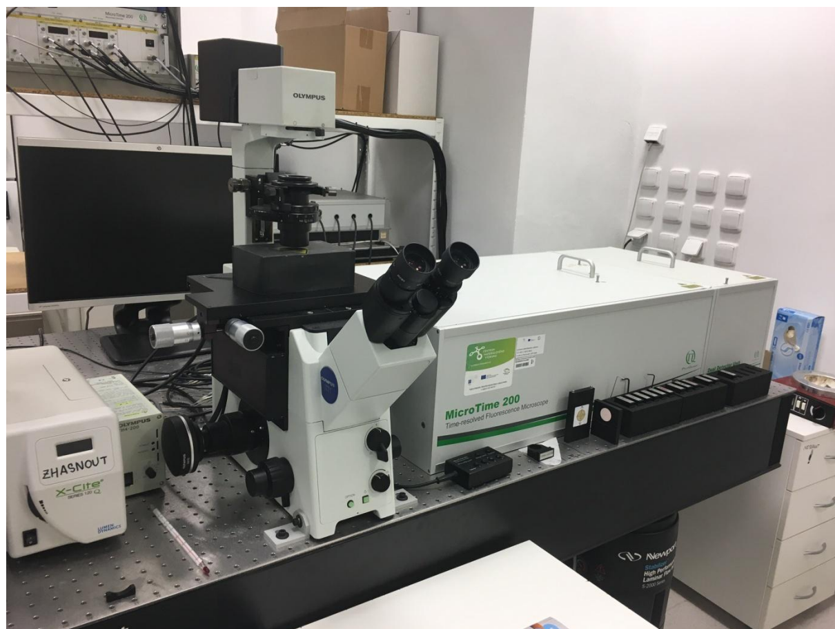
Obrázek 9: Příklad přístroje MicroTime 200 pro měření FCS
