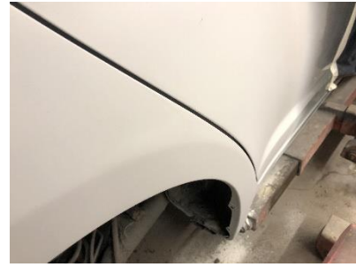
Obrázek 38 Kontrola plniče Suzuki Swift.
