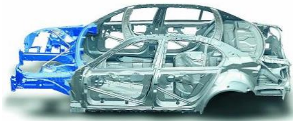
Obrázek 14 Přední sekce automobilu z hliníku. (European Aluminium Association, 2013)
