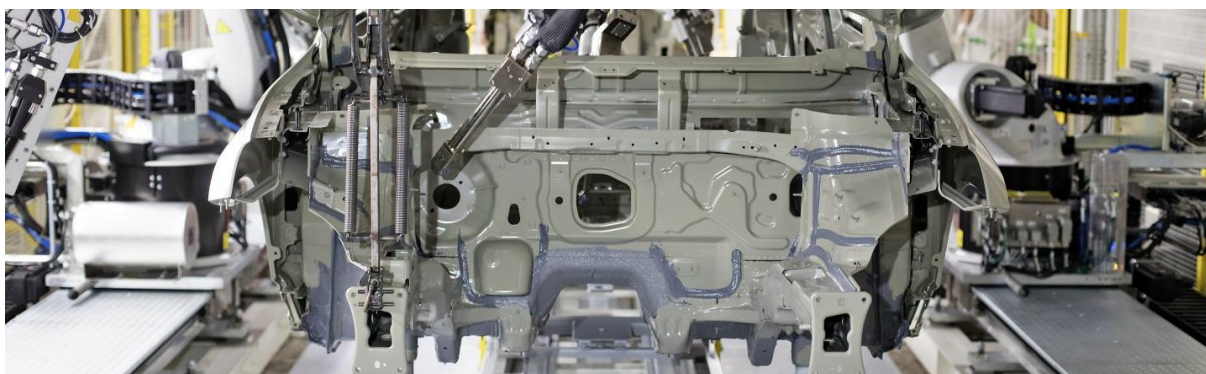
Obrázek 24 Aplikace těsnicí hmoty. Dostupné z Škoda Storyboard
