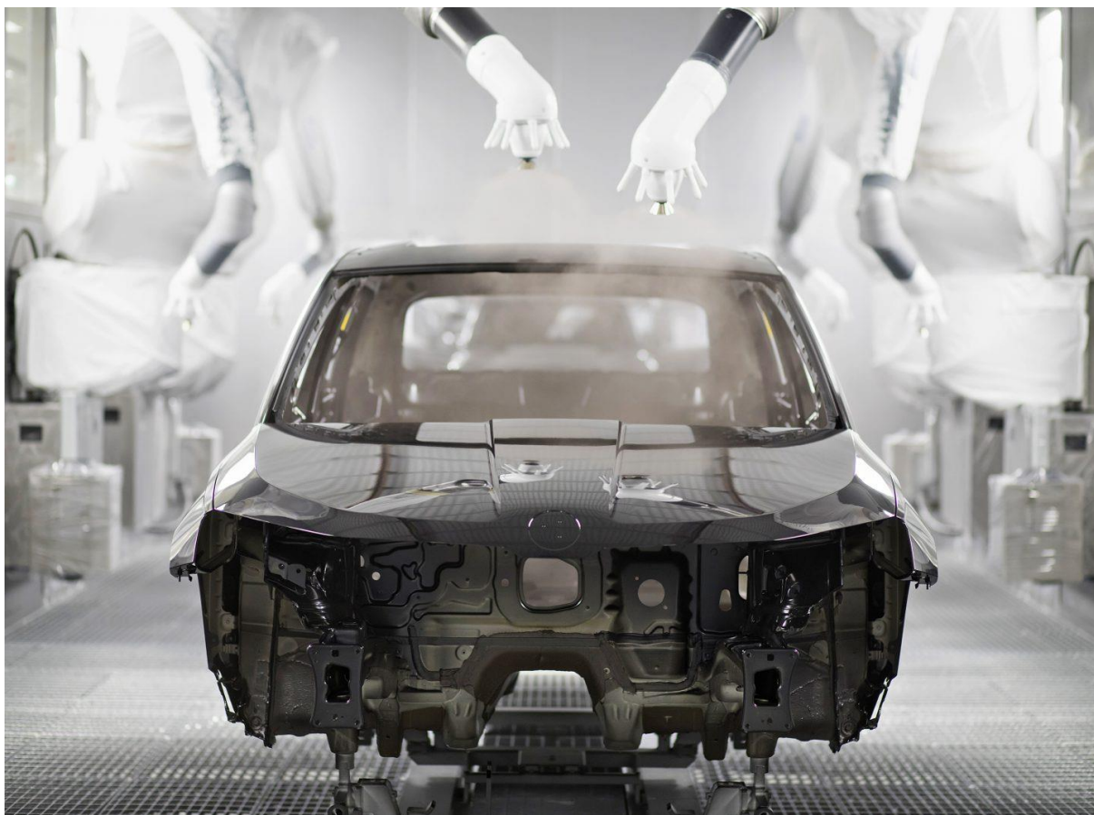
Obrázek 27 Lakovací roboti aplikující bezbarvý lak. Dostupné z Škoda Storyboard
