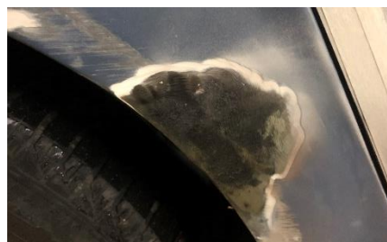
Obrázek 33 Zčernání povrchu působením odrezovače.
