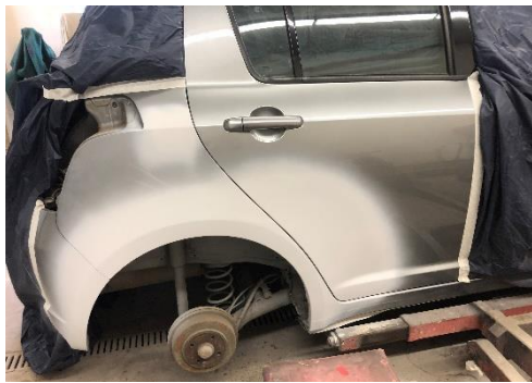
Obrázek 39 Vrstva plniče Suzuki Swift.
