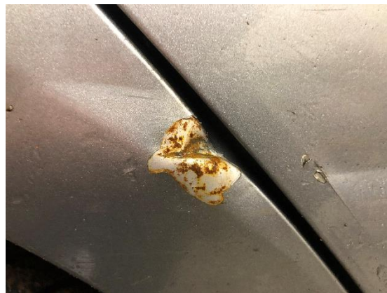
Obrázek 32 Příklad zvolení opravy povrchových úprav - detail.
