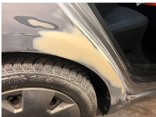
Obrázek 36 Tmelení poškozené karoserie Suzuki Swift.
