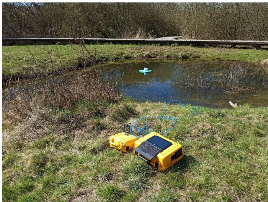
Obrázek 2: Měření emitujících plynů přístrojem UGGA; Zdroj: Rulík, 2020
