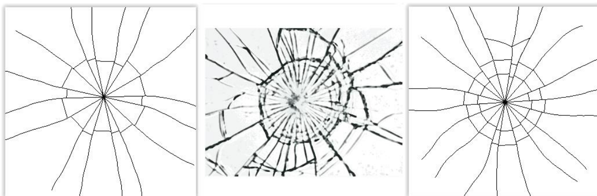
Obrázek 19 - Výsledné lomy simulace porovnané se skutečným obrázkem rozbití. Obrázky a), c) výsledky simulace, b) převzato: http://www.wisegeek.com/what-is-a-glass-break-sensor.htm#
