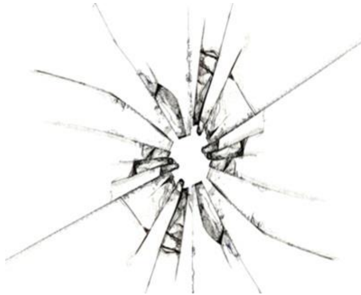
Obrázek 4 - Malý pavouk rozpadu skla s průletem předmětu skrz tabuli, zdroj: http://www.findfreegraphics.com/
