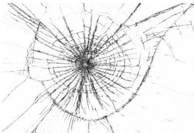
Obrázek 1 - Velký pavouk rozpadu skla bez odpadnutí střepů, zdroj: http://www.interestingfactss.com/
