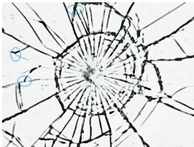
Obrázek 11 - Velký pavouk rozpadu skla, spoje radiálních lomů, upraveno: http://www.wisegeek.com/what-is-a-glass-break-sensor.htm#
