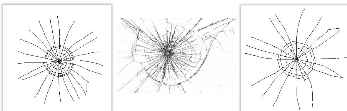
Obrázek 20 - Výsledné lomy simulace porovnané se skutečným obrázkem rozbití. Obrázky a), c) výsledky simulace, b) převzato: http://www.interestingfactss.com/
