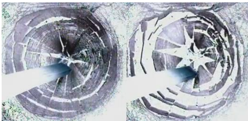
Obrázek 7 - Iterace střepů, rozdíl mezi pohybem vnějších a vnitřních střepů, zdroj:- The Discovery Slow Down! [12]
