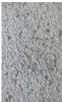
Obr. 2.3 Aperiodický povrch odlitku [11]
