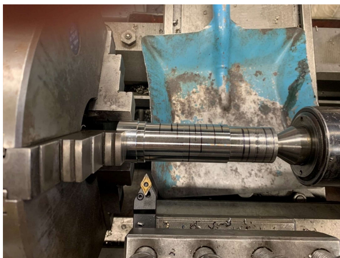
Obr. 3.1 Soustružení vzorků na soustruhu SU 50/1500
