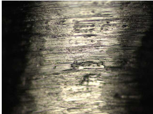
Obr. 3.7 a 3.8 Povrch obrobku a třísky při posuvu f = 0,15 mm/ot
