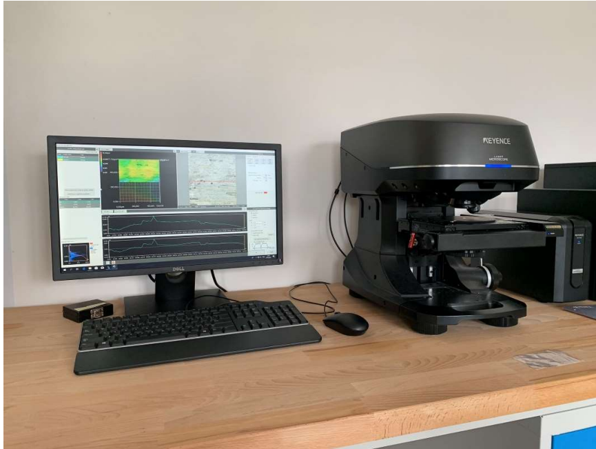
Obr. 3.9 3D laserový skenovací konfokální mikroskop KAYENCE VK-X1000
