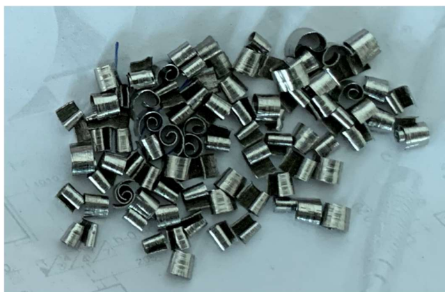
Obr. 3.2 Příprava třísek k měření.
