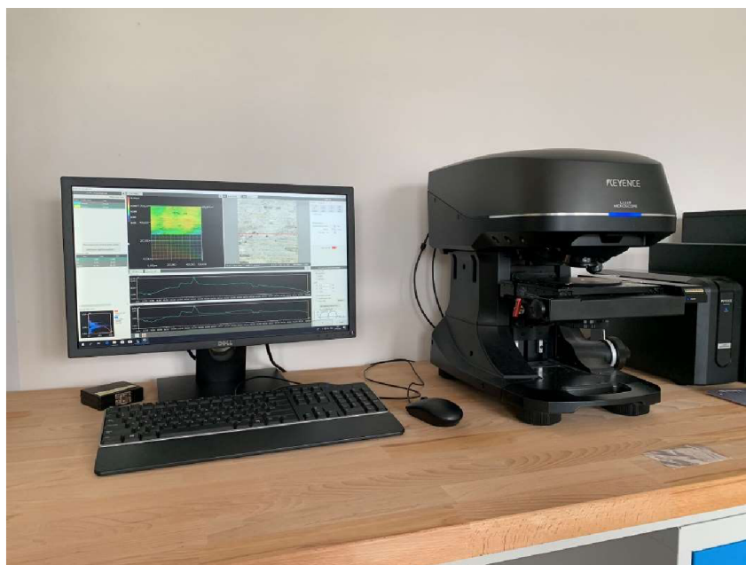
Obr. 3.9 3D laserový skenovací konfokální mikroskop KAYENCE VK-X1000
