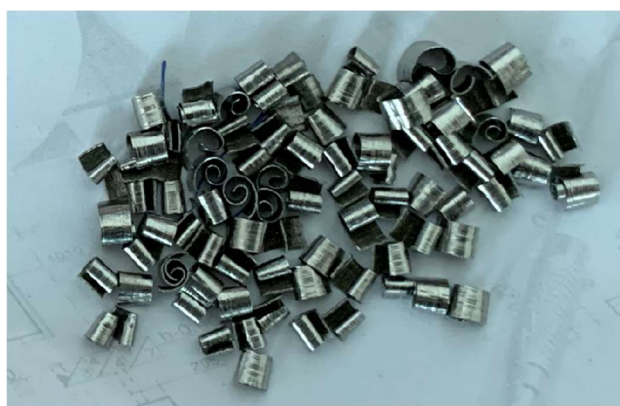
Obr. 3.2 Příprava třísek k měření.
