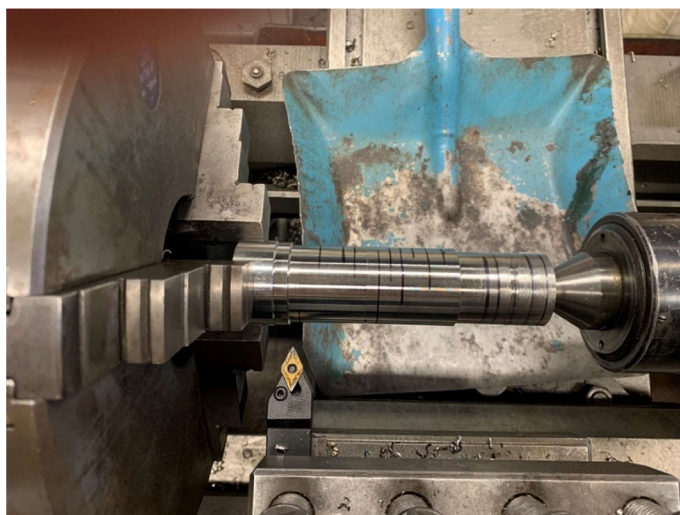
Obr. 3.1 Soustružení vzorků na soustruhu SU 50/1500
