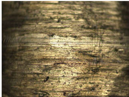
Obr. 3.5 a 3.6 Povrch obrobku a třísky při posuvu f = 0,1 mm/ot
