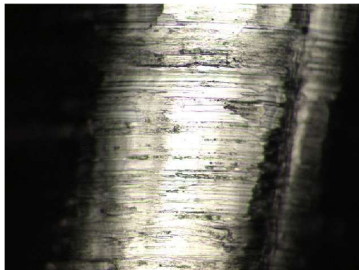
Obr. 3.3 a 3.4 Povrch obrobku a třísky při posuvu f = 0,05 mm/ot
