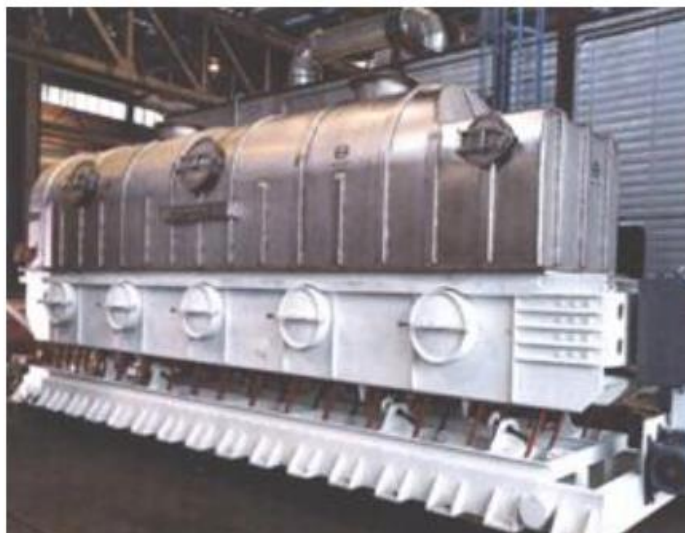
Obrázek 4.8: Fluidní sušárna, zdroj: [16]
