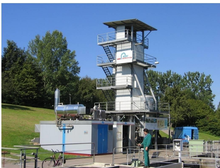
Obrázek 5.14: Příklad zplyňovacího zařízení, zdroj [42]
