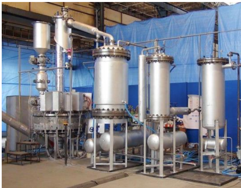
Obrázek 5.12: Pohled na pyrolýzní jednotku ve výzkumném centru AdMaS, zdroj [40]
